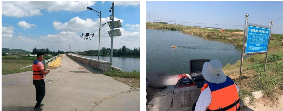
图 3-2 学校师生采用无人机、无人船进行水库地形图测绘
